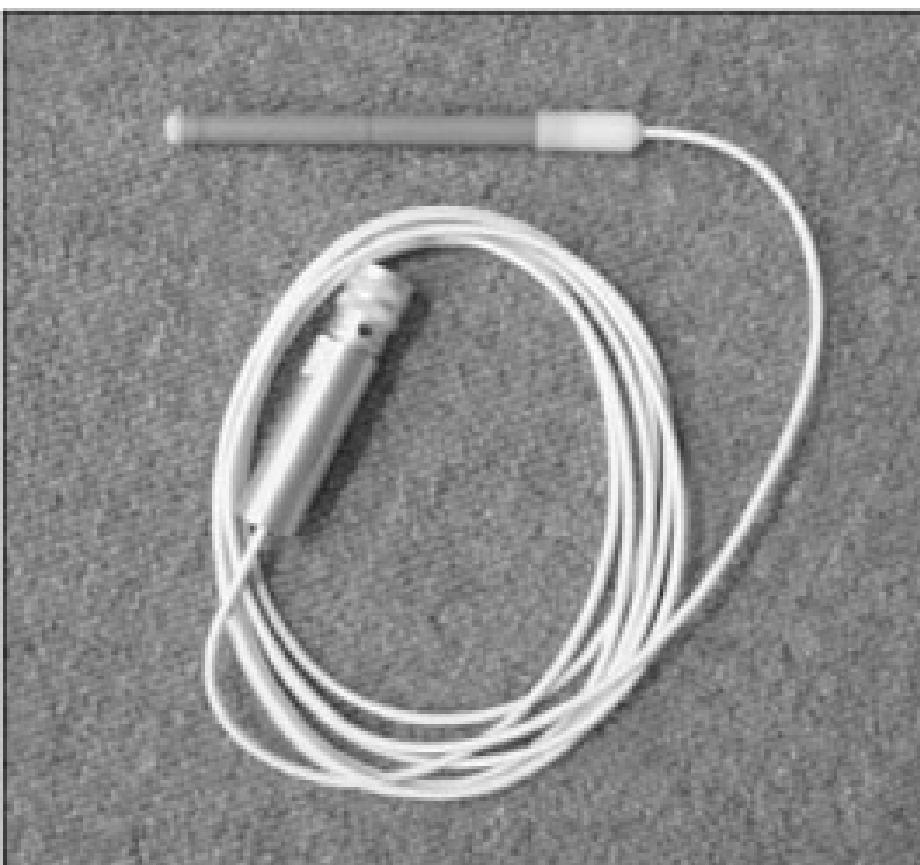
Figura 2. A: Câmara de ionização em forma de lápis utilizada para medida de dose em TC. B: Monitor de radiação.
